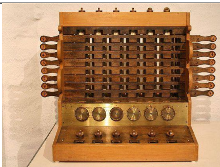
Nachbau der Rechenmaschine von Schickard 1623
