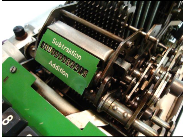
Abb. 4: Modell TVK-S mit Zusatzanzeige (Gehäuse abgenommen)
