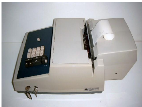
Kienzle 102 K, Schalterquittungsmaschine mit Vorsteckeinrichtung für Kassenbelege
