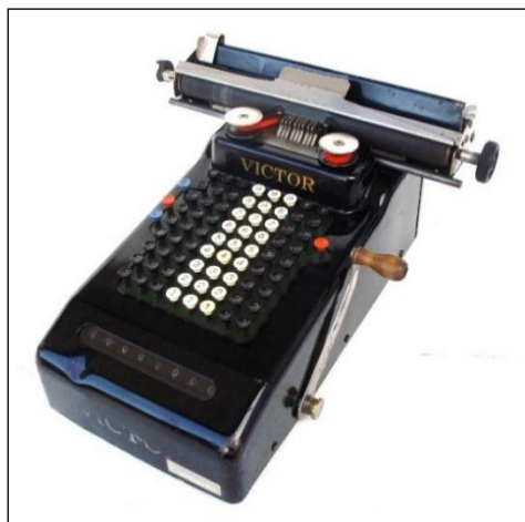
Abb. 3: Einspezies- Handaddiermaschine Victor Modell 210, mit 32,5 cm-Schiebewagen,
