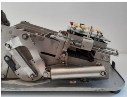
Arbeitsweise ähnlich der Ölfüllung; hier jedoch wird die Luftfüllung beim Rücklauf komprimiert, so dass ein verzögerter Anstieg der Dämpfung erreicht wird.
