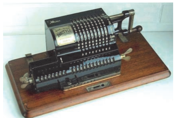
Dactyle Nr. 2263 (französische Nummerierung): immer noch mit Löchern für das Steckkomma
