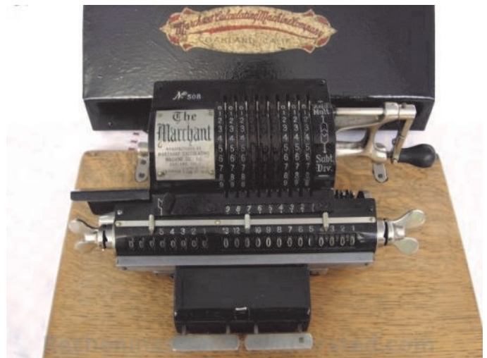
Marchant Nr. 508 mit Schlittenautomat (1916)
