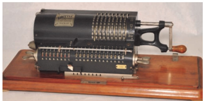
Dactyle Nr. 10.791 mit rot-weißen Ziffern und automatischer Add-Löschung (spitzer Hebel links)
