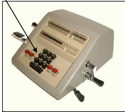
Version III: Beispiel Vierspezies-Kurbelmaschine Modell CM2-16 mit Zehner-Blocktastatur
