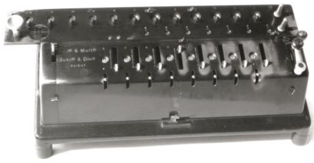
Beispiel: TIM Modell II mit Eingabeanzeige links neben dem Schieber
