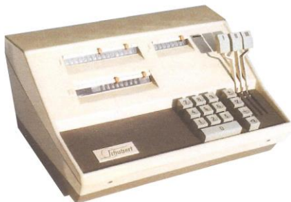
Beispiel 3: Schubert Modell E mit Zehner-Blocktastatur, wurde erstmals 1960 auf der Hannover-Messe vorgestellt 31 ; Abb.: S/N 3000183.
