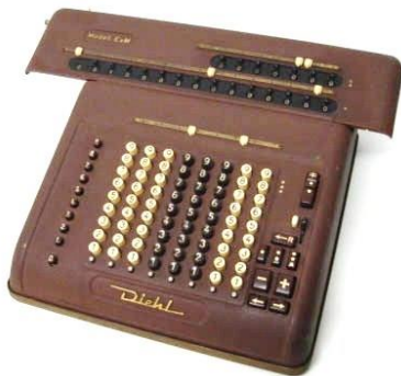
Zum Vergleich: Diehl Modell EvM 15 mit Multiplikatorwahltastatur auf der linken Bedienfeldseite.
