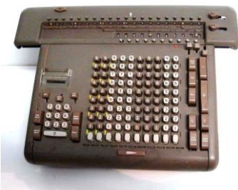
Beispiel 2: Friden Modell STW 10 von 1950, Eingabekapazität des Multiplikators 10-stellig, Tastatur mit Eingabeanzeige.
