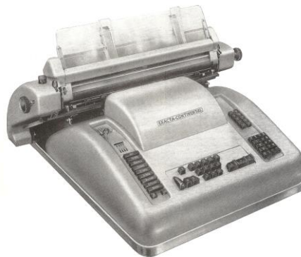
Abb. 9: Exacta-Buchungsmaschine Modell 6000 mit zwei Stiftschlitten
