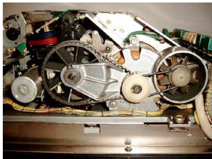
Abb. 8: Kombinierter Drucker- und Gebälseantrieb
