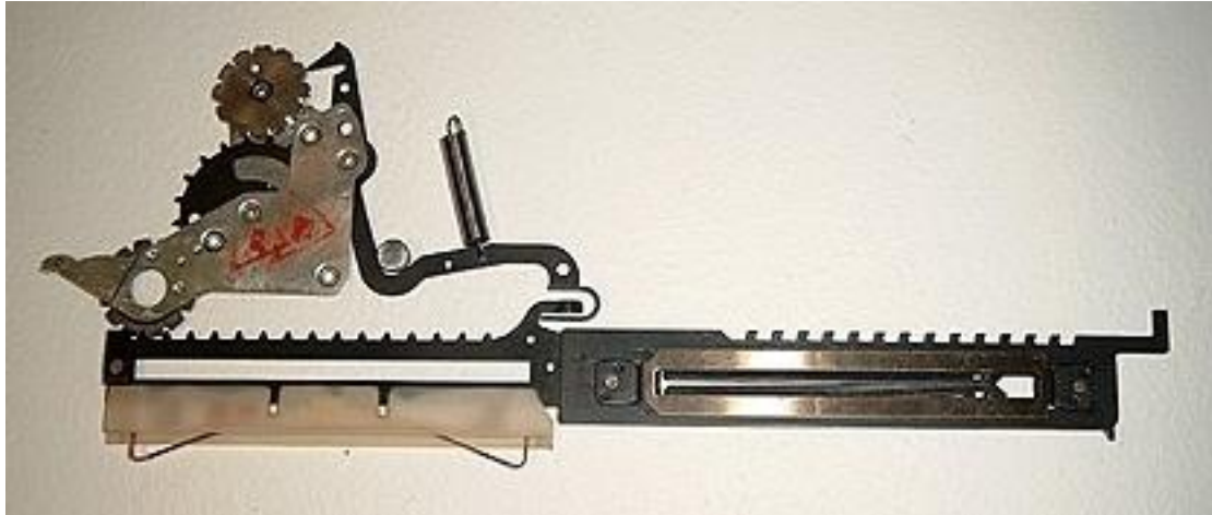
Abb. 14: Originalausführung einer Riegelzahnstange
