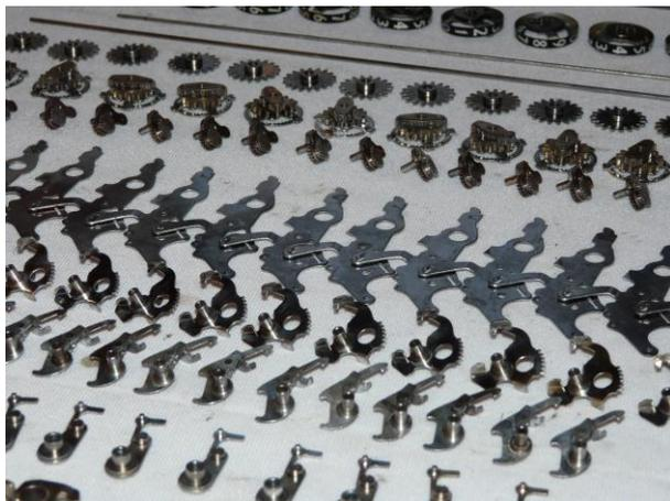
konnte ich endlich durch Anfertigung einer Holzschablone den gewünschten Erfolg erzielen. Natürlich war meine eingesteckte Prüfachse zur korrekten Justierung des Zahnradengriffs der 20 Planetengetriebe zu dick und ich musste erneut Lehrgeld bezahlen: Aufgrund sich aufbauender Verspannungen ab Stelle 13 war kein weiterer Zusammenbau mehr möglich; ich zerlegte die Zählwerkseinheit wieder und ich schmiss alle Teile auf den Werk-tisch zurück. Eine Stange Blumenbindedraht mit 0,8 mm
