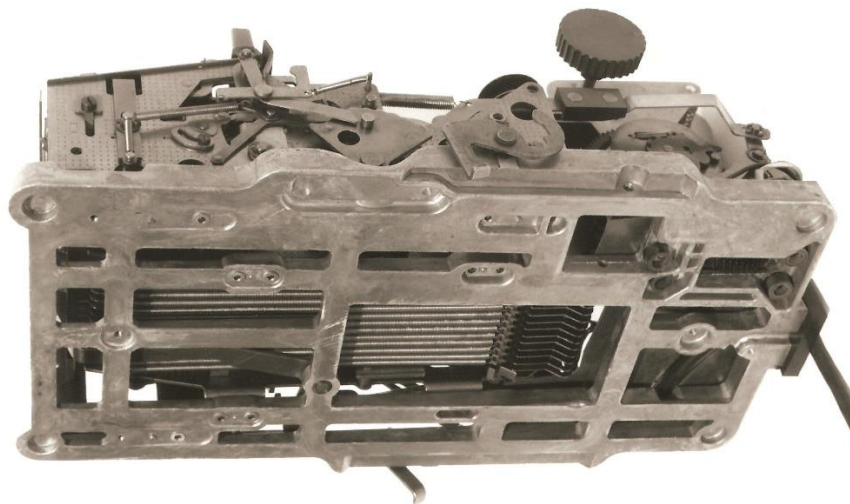
Abb. 12: Bodenchassis der Maschine aus Aluminium-Guss
