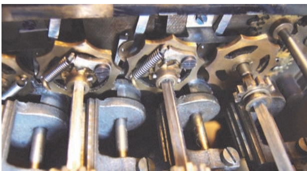
Abb. 22a: Neuartige Zehnerübertragung mit einem Gesperre sorgen für unabhängige 10er-Überträge in beiden Resultatwerken
