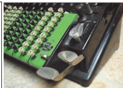
Abb. 34: UNITAS Nr. 14.994 mit Motor und zwei Zusatz-tasten auf der rechten Maschinenseite. Mit ihnen kann man jeweils einen Schlitten anheben und dadurch auskuppeln, nicht aber den Wagen verschieben.
