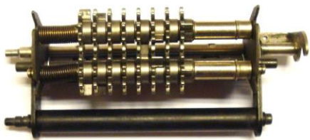
Beispiel: Untergruppe Zählwerk, Zählräder mit Zehnerschaltnocken
