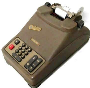
Beispiel: Odhner Modell X 11 C-6 mit feststehendem Zählrädersatz
