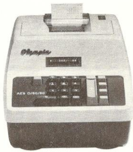
Beispiel 5: Olympia-Modell AE 9 D/60/60 (2183-060) für das Addieren von Minuten und Sekunden.
