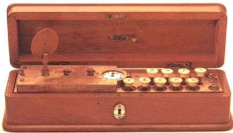
Friedrich Hebentanz` Arithmometer von 1873 mit Federtriebwerk
