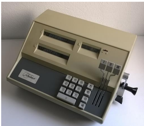
Beispiel 3: Schubert Modell E mit Zehner-Blocktastatur, ein Prototyp wurde 1960 auf der Hannover-Messe vorgestellt 32 ; Abb.: Serienausführung, S/N 300183.
