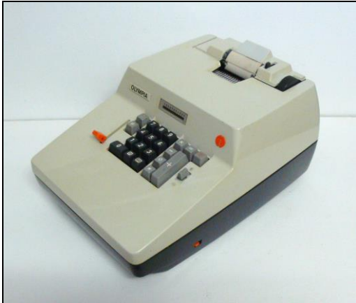
Beispiel 3: Olympia Modell RAS 4/12, vollautomatische Multiplikation ohne zusätzliche Multiplikatortastatur.
