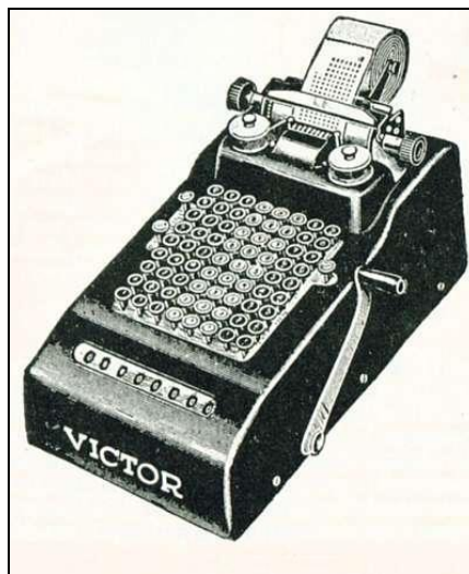
Abb. 4: Victor Modell 2, Ziffern- und Bedientasten mit Tastenring und Glasabdeckung.
