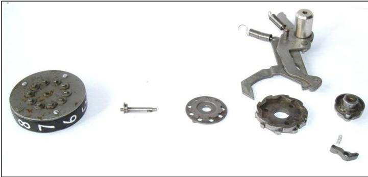
Die wesentlichen Bauteile für den Zehnerübertrag sind in Rotation um eine dünne Welle, an deren Ende sich eine sehr kleine Exzentrerscheibe befindet. - **v. l. n. r.:** **Ziffernrad** mit einem Kranz aus 10 aufgenieteten Miniatur-Bolzen und innenliegender Torsionsfeder (nicht sichtbar), **Steckwelle** mit kleinem Exzenter, **9- Muldenscheibe**,
