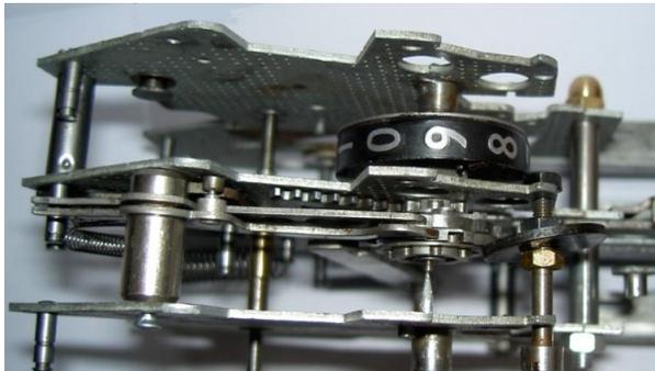
**Dacometer-Antriebssystem (zerlegte Maschine Nr. 15.765, grünes Gehäuse).** Das Bild zeigt, wie eng die filigranen Bauteile in einander verschachtelt sind. In der Bildmitte das gezahnte Antriebssegment und das Ritzel, verbunden mit dem Klinkenträger
