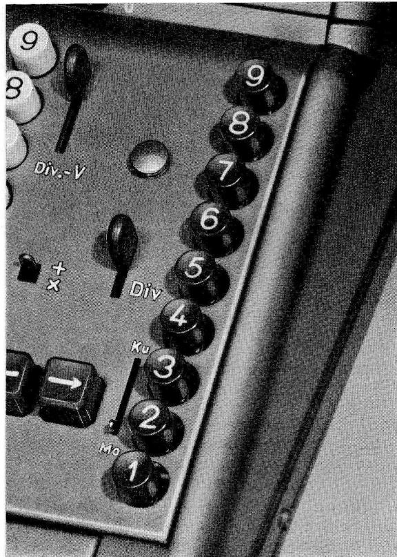
Die Multiplikatorwahltasten (12) liegen am rechten Gehäuserand der Maschine und dienen zur Multiplikation, wobei die Stellen des Multiplikators einzeln nacheinander eingetastet werden. Nach jedem Ablauf der Maschine verlegt sich das Gleitlineal selbsttätig in die nächste Stelle.
