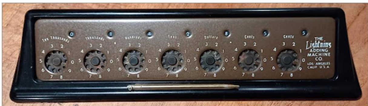
Fig.: Le résultat de 10 \div 7 sur une Lightning Adding Machine ( 1.4285 + 5 comme reste)
