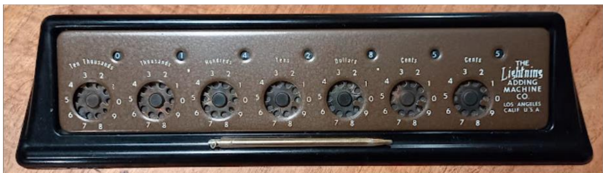
Afbeelding: Het resultaat van de deling 10 \div 7 op de Lightning Adding Machine (1,4285 + rest 5)
