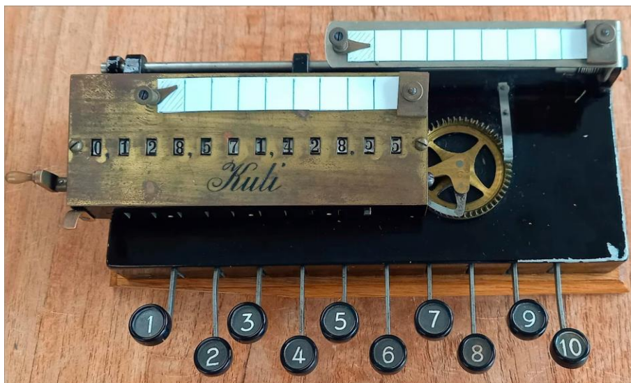
Afbeelding: Het resultaat van 90 \div 7 met 10 beduidende cijfers en een rest op de Kuli, een eenvoudige kolomopteller met tienoverdracht in drie kolommen
